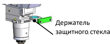
Рисунок 5.1 – Замена защитного стекла
