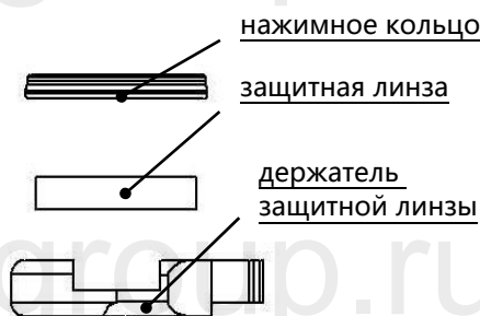
Рисунок 6.2 - Конструкция защитной линзы
