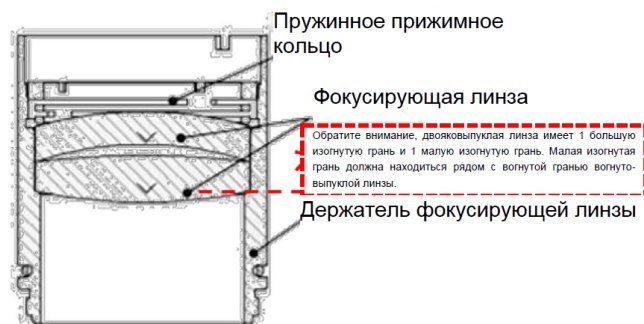
Рисунок 6.9 – Установка фокусирующей линзы
